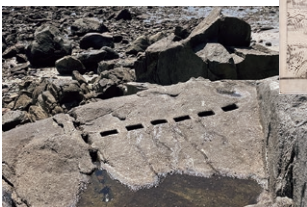
上／摂州御影石 石割りの様子 左／前島に残る矢穴石。穴が列状に並んでいる様子がわかる。
