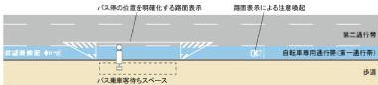
図 自転車専用通行帯においてストレート型バス停を設置する際の整備イメージ
