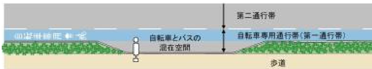
図 自転車専用通行帯においてバスベイ型バス停を設置する際の整備イメージ
