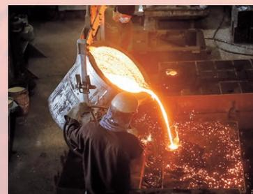
約1,500℃に溶けた金属を鑄型に注ぎ込む。事業所によって手作業で行う場合と、機械を使って行う場合がある。
