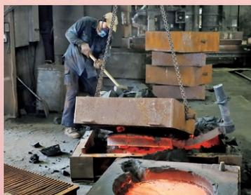
金属が冷却されるまで待ち、鑄型を取り出して鑄造品を取り出す。中子を使った場合は取り出す。
