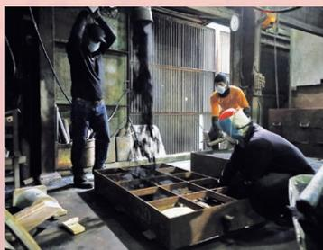
砂を使って鋳型と呼ばれる、模型の形を転写した入れ物を作る。しっかり詰めるのが高品質な製品を作るポイント。
