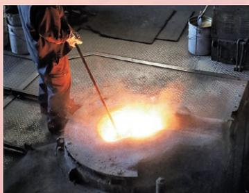
鉄やアルミニウム、銅など製品の材料となる金属を、炉で溶かしながら、不純物を取り除く。
