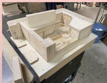
設計図をもとに、模型を作る。内部に空洞を作る場合は「中子」と呼ばれる型を使う。
