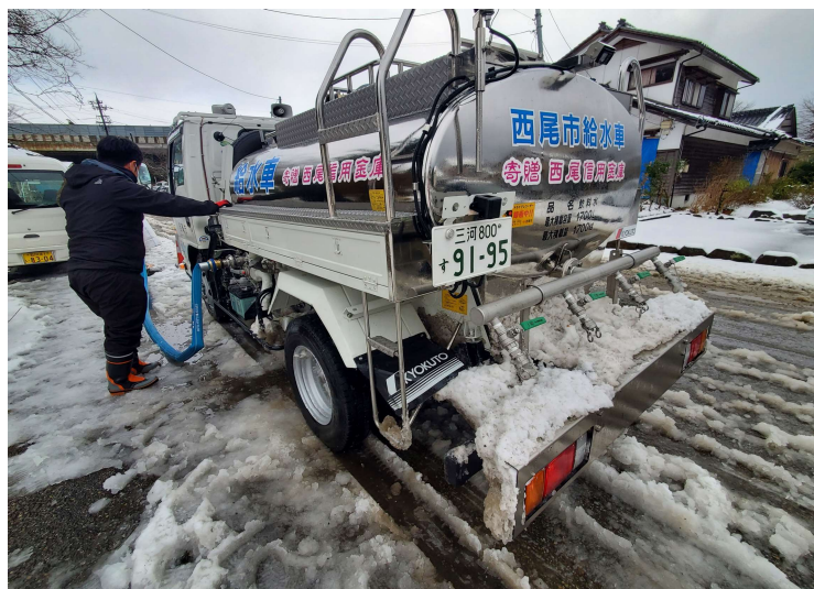
七尾市内消火栓より補水作業中
