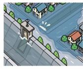
Là việc ngập nước do nước tràn vào trong đô thị khi mưa rơi trong đô thị vượt quá khả năng tiêu thoát của kênh, cống thoát nước và đường ống nước thải, nước sông bị đầy do mưa lớn nên không thể thoát nước được.
