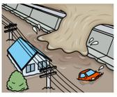
Là việc ngập nước xảy ra do bão và mưa lớn, v.v. làm nước sông tràn ra khỏi đê bao, hay do vỡ đê.
