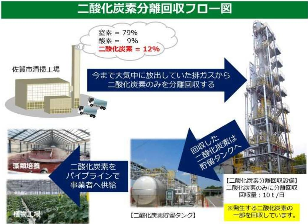
図 9 佐賀市清掃工場における二酸化炭素分離回収フロー
