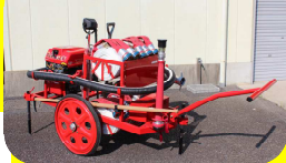
可搬ポンプ (台車付き)
