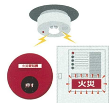
自動火災報知設備
