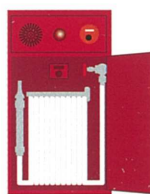
屋内消火栓設備
