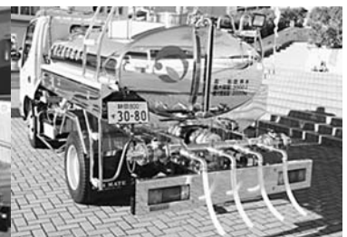
牧之原市に配備された加圧式給水車 加圧ポンプを装備した給水車で、公共施設や病院などに設置された受水槽への補給や、災害時の応急給水用のポリタンク、給水バックへの給水も短時間に効率的に行うことができる車両
