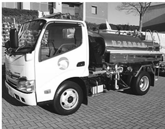
牧之原市に配備された加圧式給水車 加圧ポンプを装備した給水車で、公共施設や病院などに設置された受水槽への補給や、災害時の応急給水用のポリタンク、給水バックへの給水も短時間に効率的に行うことができる車両
