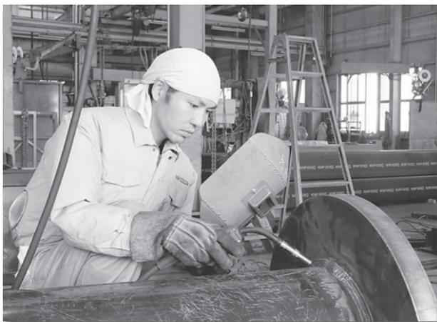
産業機械向けの大型金属部品を製作する株式会社牧製作所。特に大型製缶品を得意とし、鋼材切断から溶接、熱処理、加工、塗装までを自社で一貫生産できる高い技術を誇ります。
