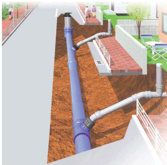
下水道管のしくみ
