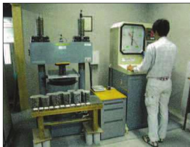
圧縮強度テストの様子
