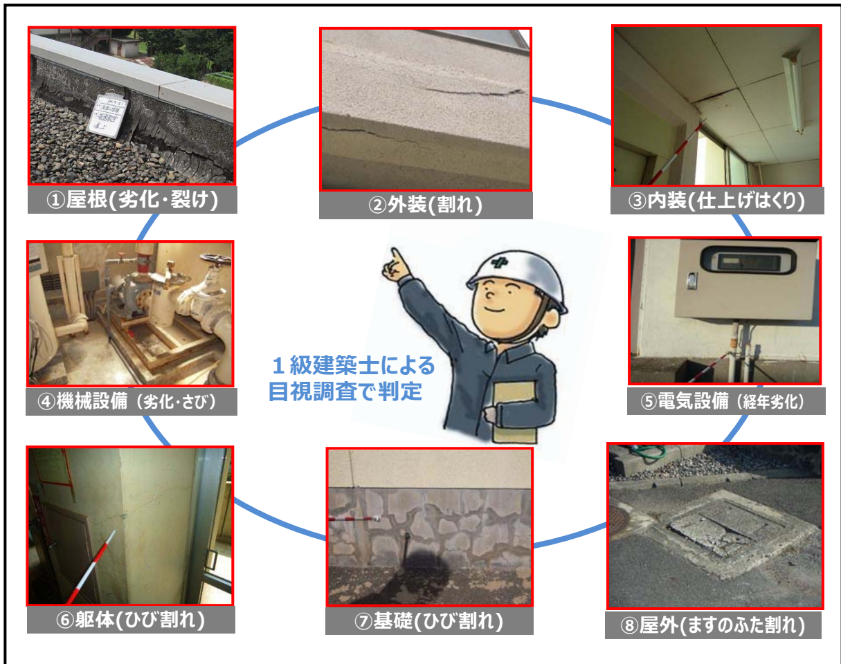
（図表2-6）建築物劣化調査方法（イメージ図）
