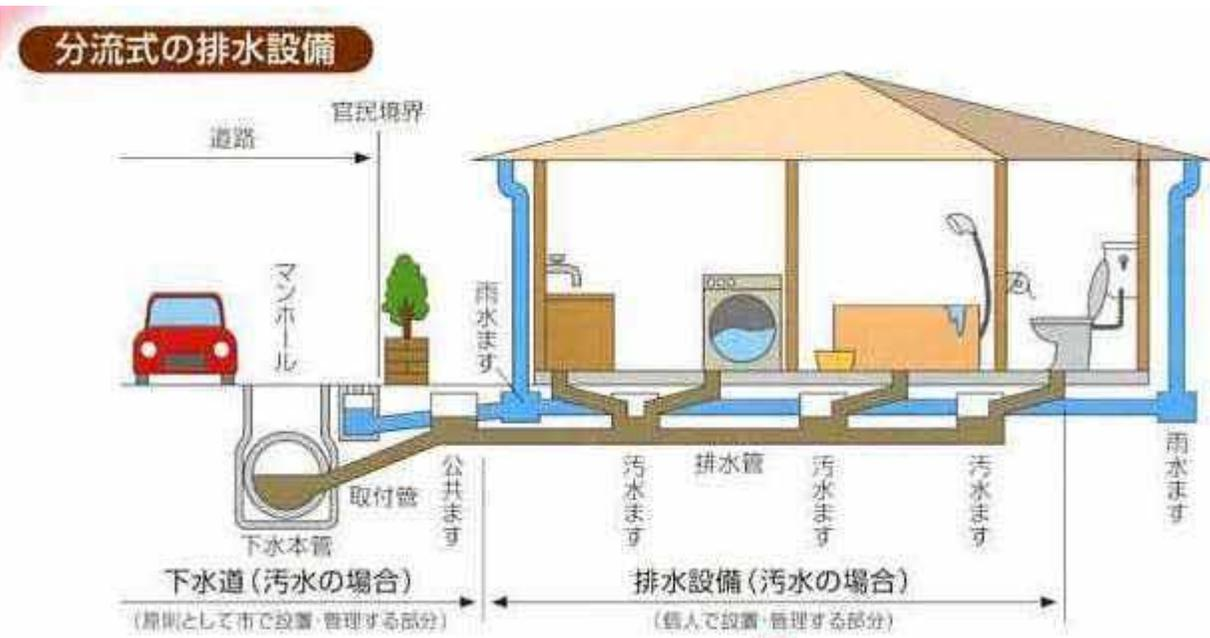
分流式: 排水を汚水と雨水に分離し汚水は下水道管へ、雨水等は側溝・排水路に流す方式のことです。
