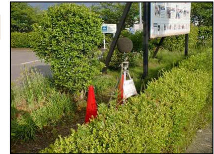
騒音測定の様子
